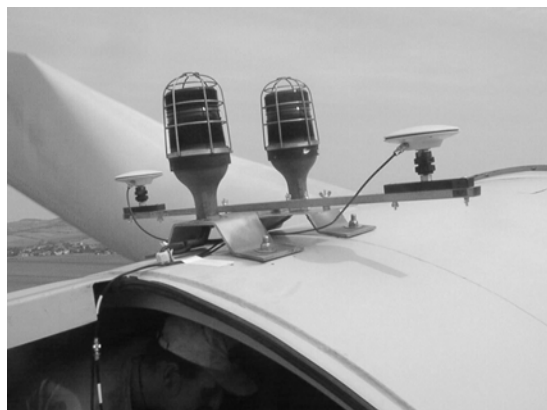
Abbildung 3: GPS-Empfänger am Dach der Gondel
