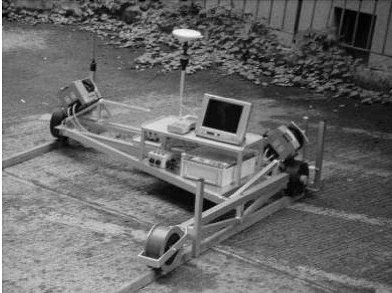
*Abbildung 1: Gleismesswagen mit GPS-Antenne, Aktivprisma und Laserscannern*
