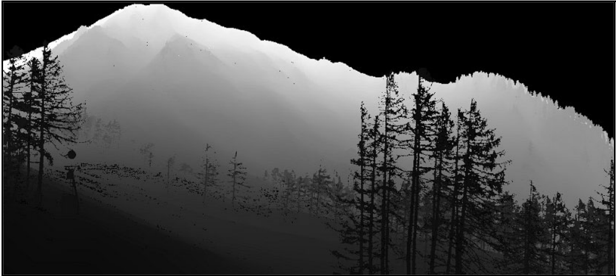
Abbildung 3: Laser-Entfernungsmessung vom Präbichl / Steiermark (grauwertkodiert: schwarz = 10 m, weiss = 1200 m)
