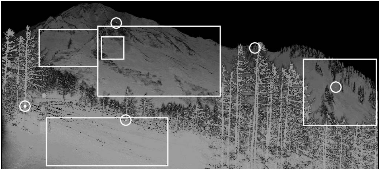
Abbildung 4: Reflektivität des Laserstrahls an der Oberfläche zu Abbildung 3 (grauwertkodiert: hell = gute Reflektivität, dunkel = schlecht). Teilregionen und Referenztargets sind markiert.
