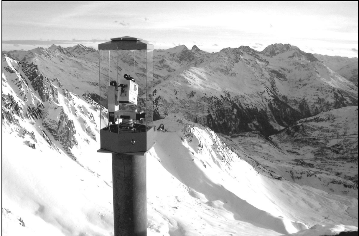
Abbildung 2: Laserscanner LPM-2k im wetterfesten Gehäuse montiert auf einer Konsole nahe der Valluga Seilbahnstation am Arlberg / Tirol.
