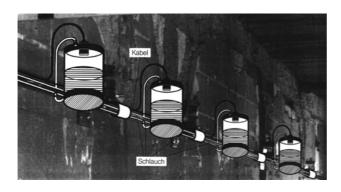
Vorwiegend in und an Gebäuden. Um (differenzielle) Setzungen innerhalb eines Bauwerkes zu messen. Das System ist vor allem "erste Wahl" wenn mehrere Punkte automatisch überwacht werden müssen. insbesonders wenn keine dauerhafte Sichtverbindung zwischen den einzelnen Messstellen garantiert werden kann.
