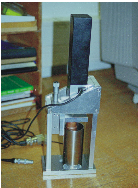
Abb. 7: Kalibriereinrichtung für USM25
