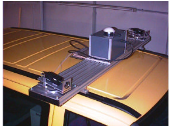
Abb. 1 – Das mobile Straßen-Erfassungs-System (MoSES) mit einer Einzeldarstellung der Module zur Erfassung des Straßenraumes
