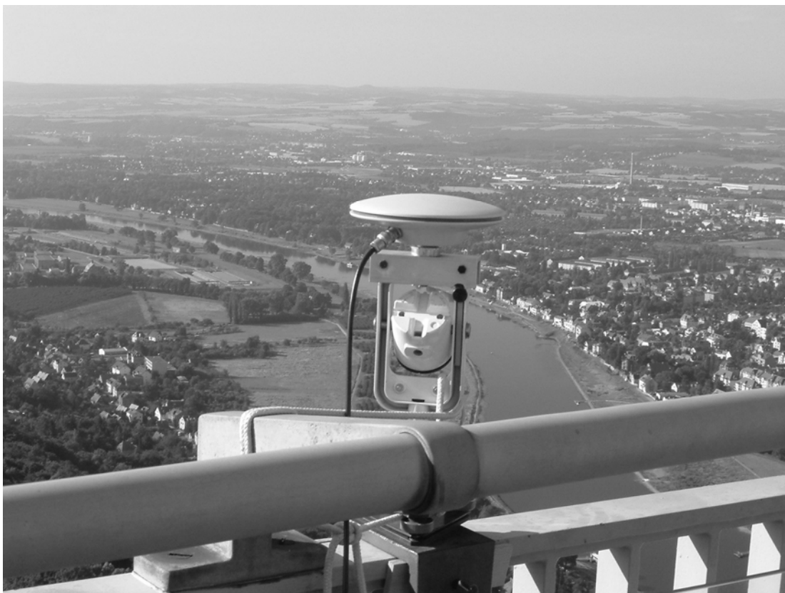
Abb. 2: Reflektor mit GPS-Antenne
